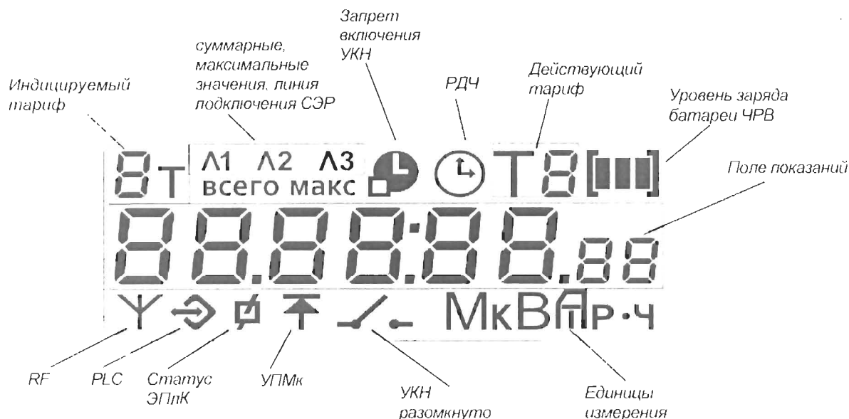
Рисунок 9 - Расположение полей дисплея счетчика
